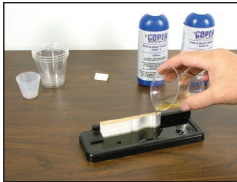
above Pour the mix into the casting tray
